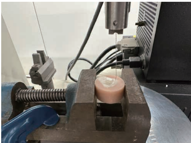
図1 撤去力測定試験装置
